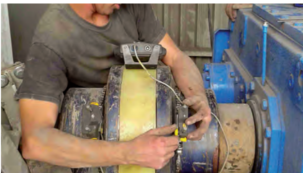
Laseruitlijning van een industriële tandwielkast
