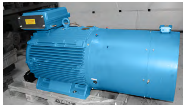
Motorische aanpassing met geforceerde koeling
